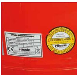
Elektrische Prüfung nach DIN
