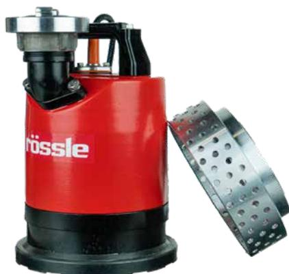
Der Schmutzwasserring macht die Pumpe FLAT-ROSS noch flexibler. Die Pumpe kann sowohl als Flachabsaugpumpe und auch als Schmutzwasserpumpe genutzt werden. Der abnehmbare Ring ist aus eloxiertem Aluminium gefertigt. Er wird mit einem Bajonettverschluss einfach an der Unterseite der Pumpe befestigt. So wird verhindert, dass die Pumpe beim Ansaugen von Dreck oder Blättern verstopft. (Schmutzwasserring kann an jeder bereits gekauften FLAT-ROSS Pumpe nachgerüstet werden)
