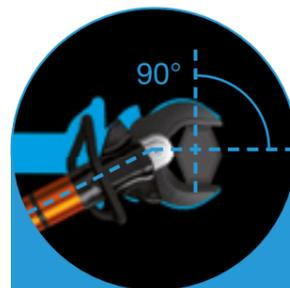
Die Messer des Inclined Cutters halten einen idealen 90°-Winkel zur Konstruktion – die Voraussetzung für effektives Schneiden. Jede andere Position verringert die Schneidleistung.
